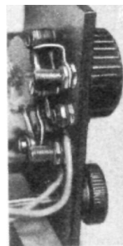
Abb. 4. Die Kurz-Lang- schaltung, gebastelt aus drei Buchsen und einer Feder
